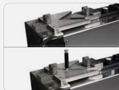
Control of diameter and 3 point micrometer Controllo diametri e micrometri a 3 punti
